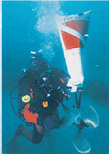
Quad Bag beim Heben einer Schiffsschraube
