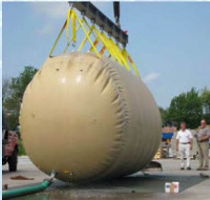
Belastungstest eines SP70000 für die U.S. Marine
