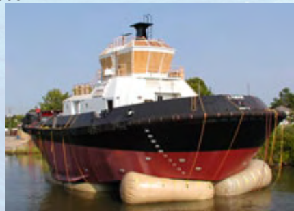
Berge Ponton im Einsatz beim Stapellauf eines Schleppers.
