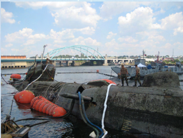
US Navy bei der Bergung eines russischen 9000 Tonnen U-Bootesmittels Berge Pontons
