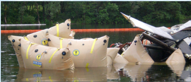
Geschlossene Hebekissen bei der Bergung eines Hubschraubers durch Feuerwehkräfte in Italien.
