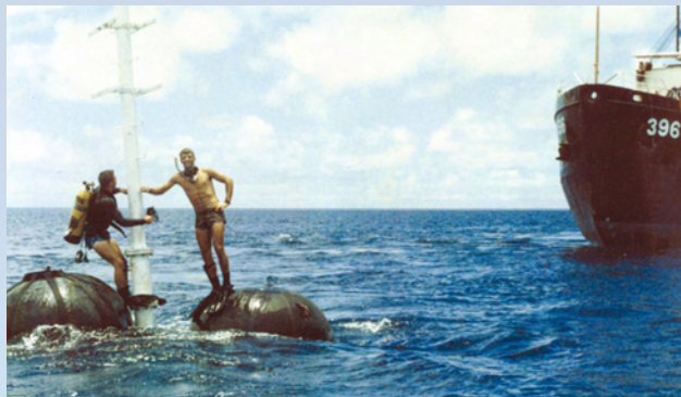
U.S.-Küstenwache bei der Inspektion einer Unterwasserkommuni- kationseinheit mit Hilfe von Professionellen Hebesäcken
